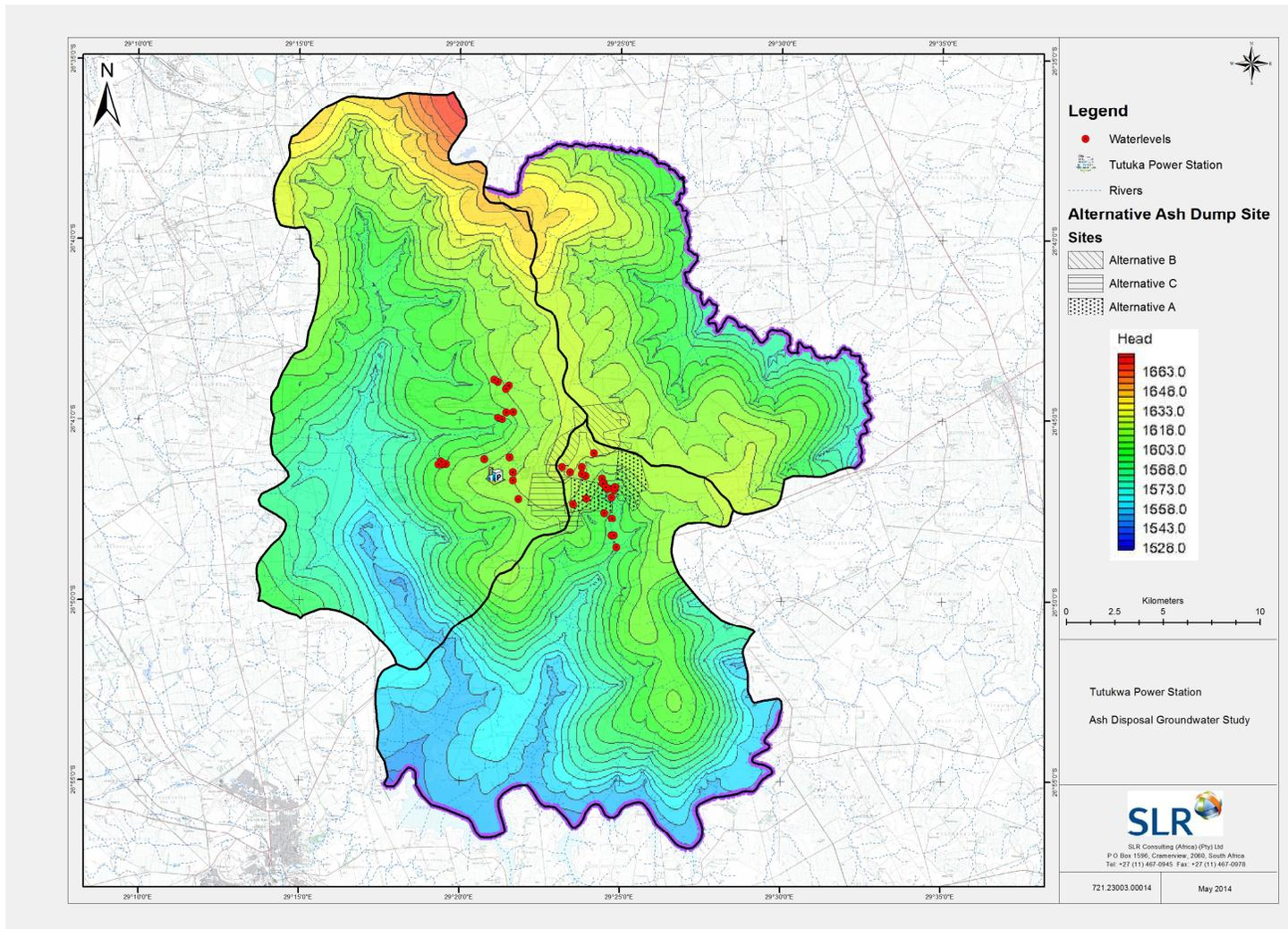
**FIGURE 3.3: MODELLED GROUNDWATER CONTOURS ACROSS THE MODEL DOMAIN**
